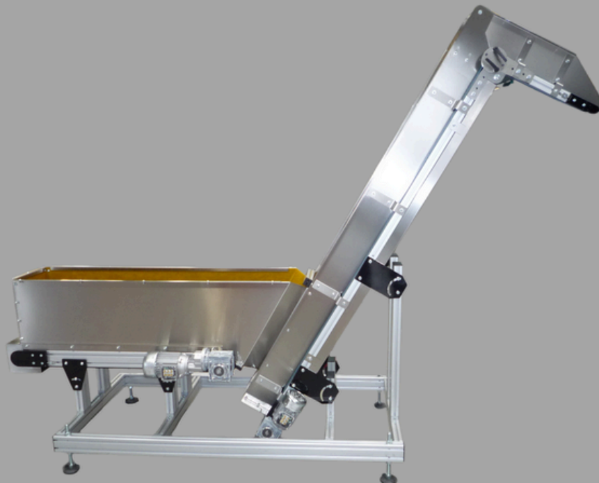
Bunkersystem zur sanften Ablage empfindlicher Teile
