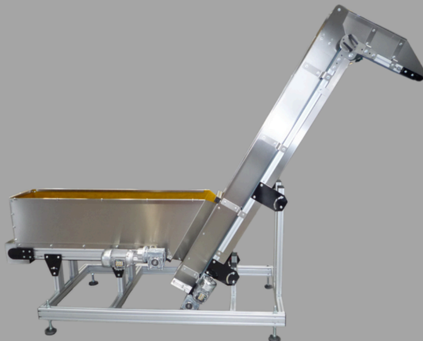
Bunkersystem zur sanften Ablage empfindlicher Teile
